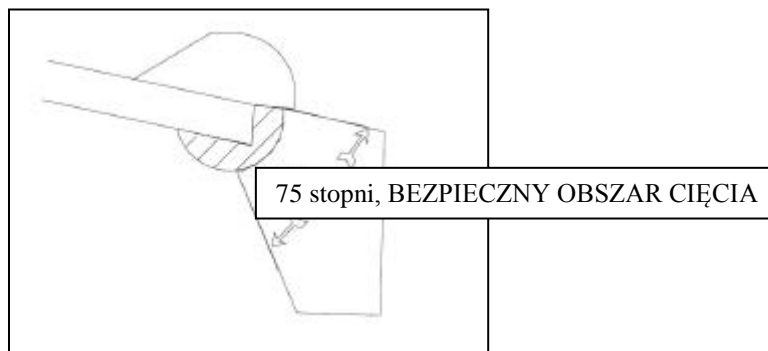
Rys. 4. Bezpieczny obszar tarczy tnącej.
